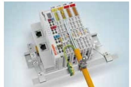
屏蔽连接系统使得屏蔽能够布置在非常靠近屏蔽线的接线端。
